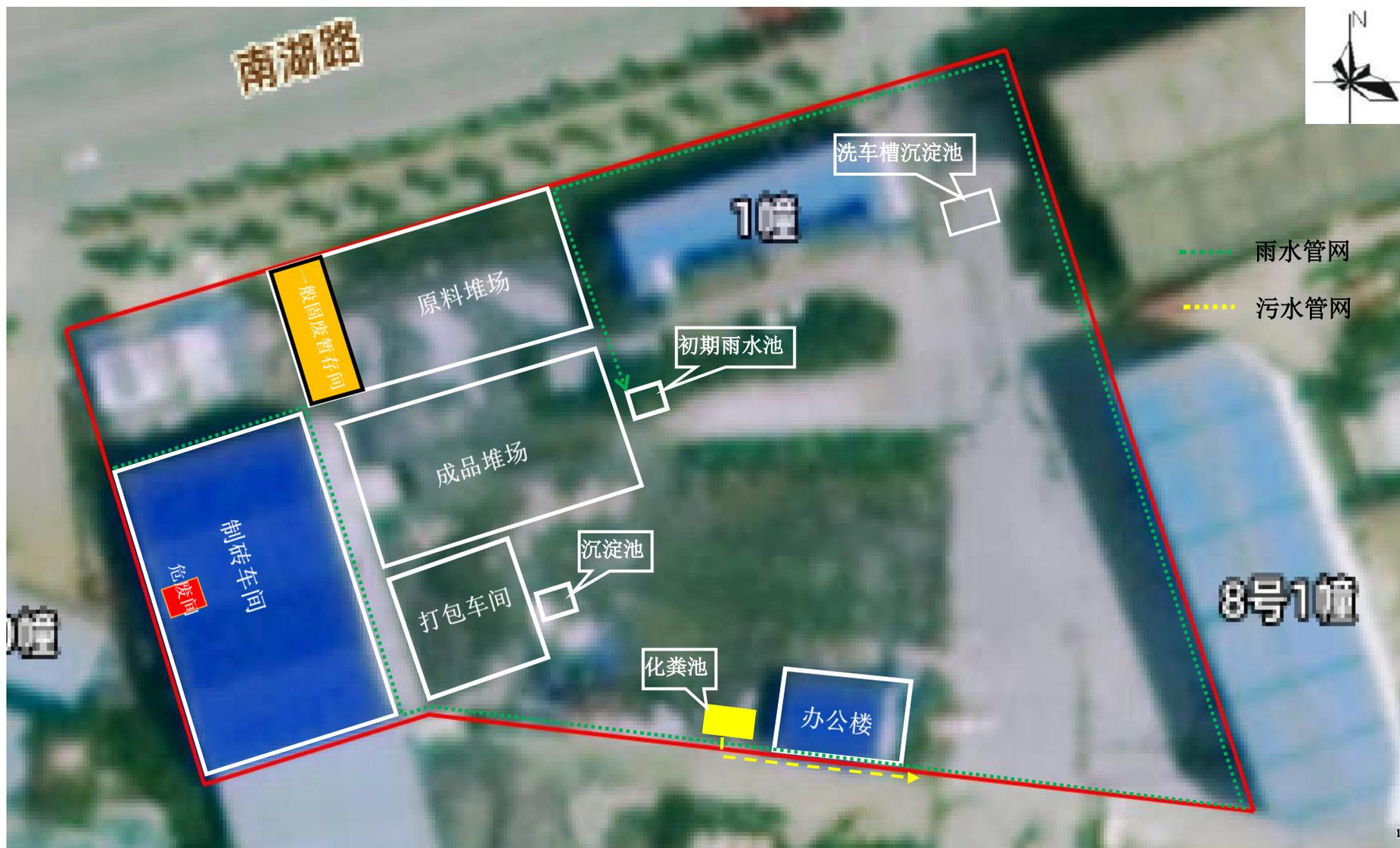
附图3 项目总平面布置及雨污管网图
