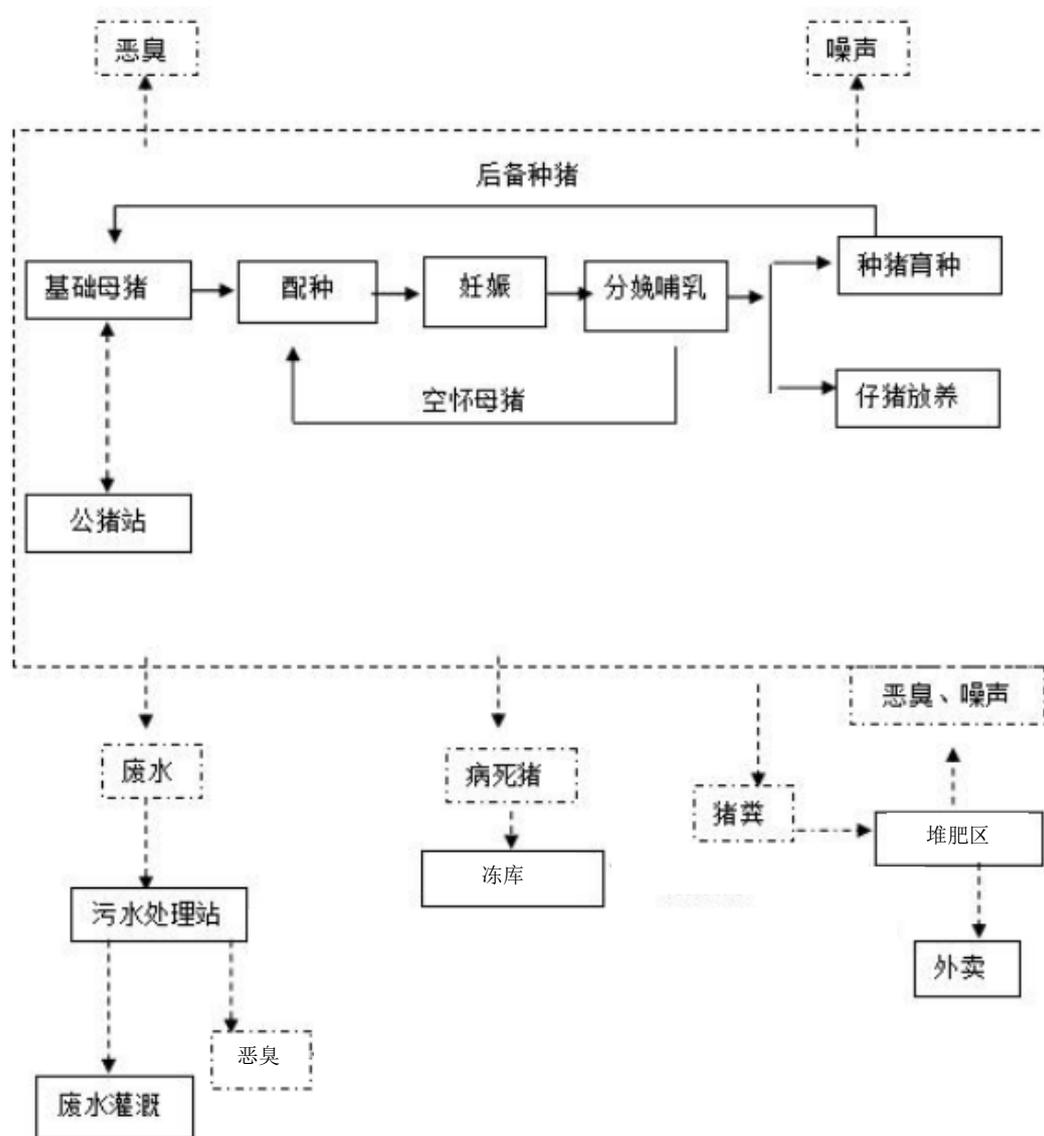
图2-2 项目生产工艺流程及产污节点图
