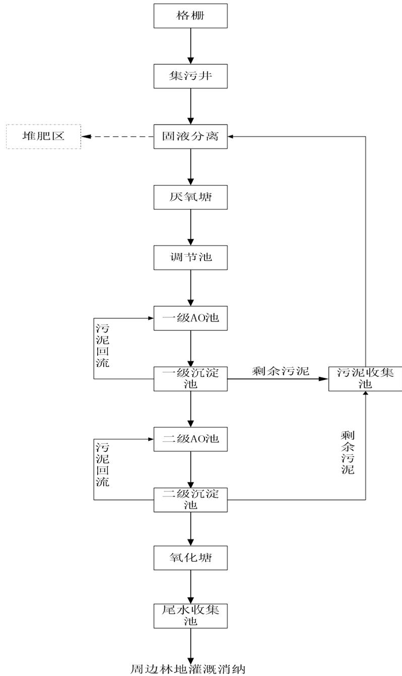
图 3-1 厂区污水处理工艺流程图
