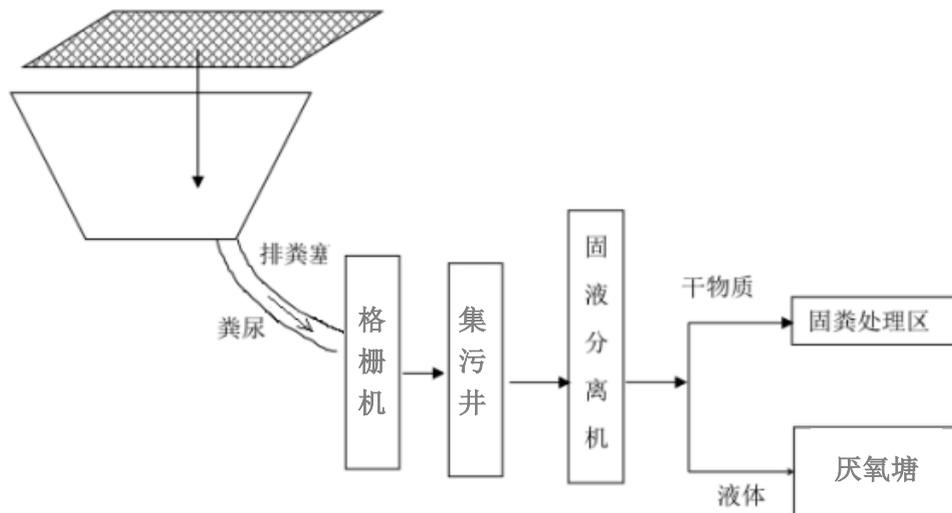
图2-3 项目清粪工艺流程图
