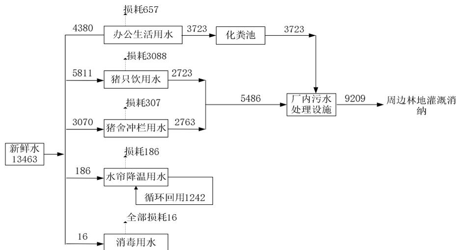
图2-1 水平衡图 (m<sup>3</sup>/a)
